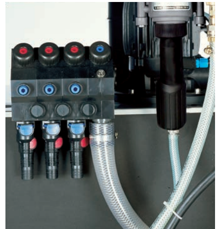
› Rückansicht mit Ejektorblock, Feuchtmittel-Anschlüssen und Zusatzmittel-Dosiersystem fluidos
