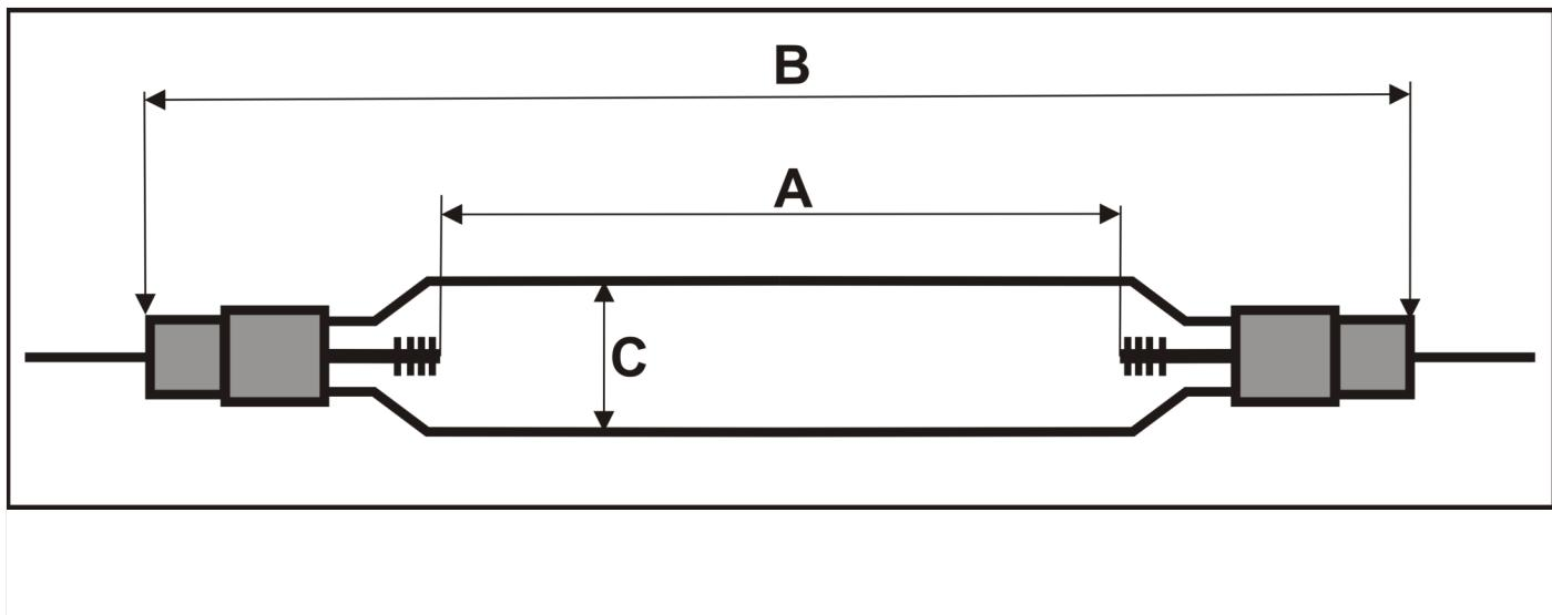
**A= Elektrodenabstand Arc / Length:** 146 mm      **Sockel / Base:** 79
