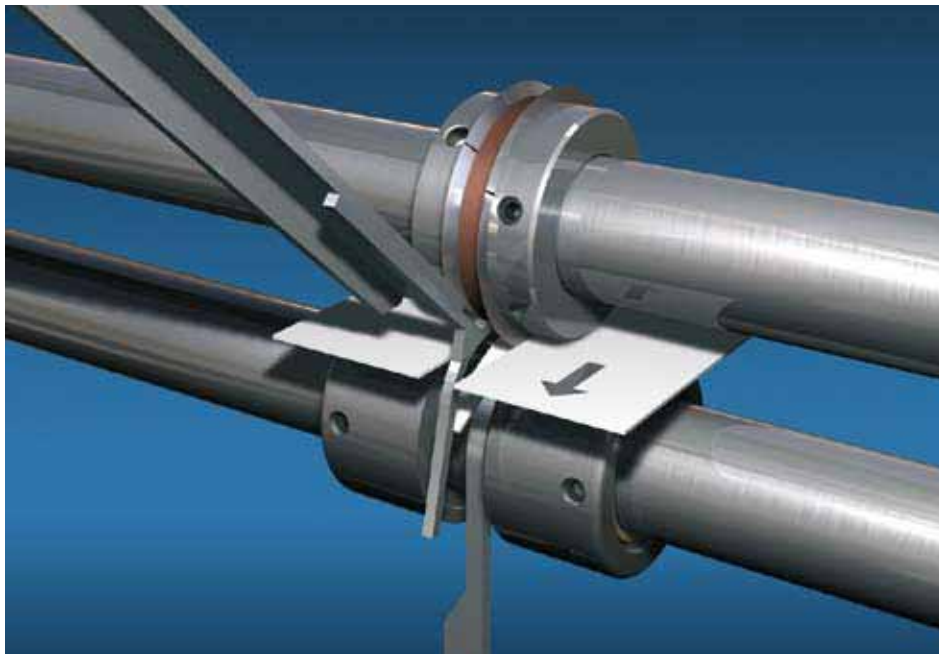
Streifenausschnitt nach dem Parallelbruch/Strip trimming after the parallel fold/Coupe double après le pli parallèle/ Recorte de tiras tras el plegado paralelo
