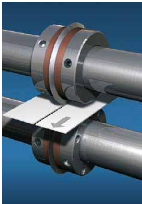
Trennschnitt mit Doppelkreismesser, auch als Randbeschnitt einsetzbar/Parting cut with dual circular cutter, also used to trim edges/ Coupe franche à l'aide d'une molette double circulaire, convient également pour la coupe des bords/Corte de separación con cuchilla circular doble, adecuado también para cortar márgenes
