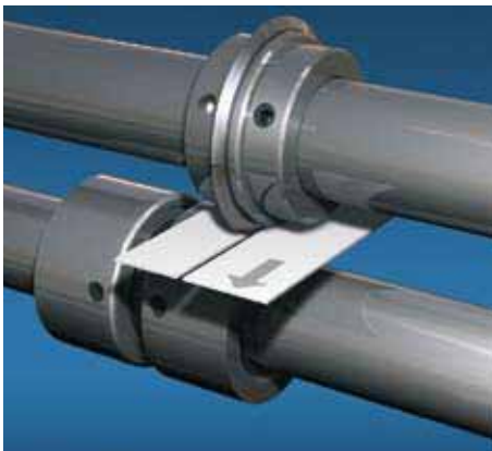
K-Maschinen: Trennschnitt gegen einfache Matrice/ K-machines: Trim cut against single die/Machines K : coupe franche sur un contre-élément simple/ Máquinas K: corte de separación contra matriz simple
