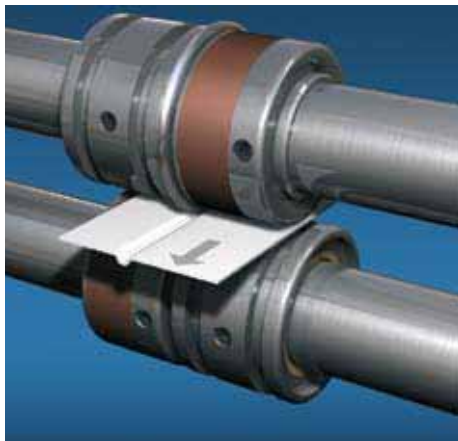
T-Maschinen: Rillen gegen Stahl/T-machines: Scoring against steel/ Machines T : rainage sur galets acier/Máquinas T: hendid contra acero
