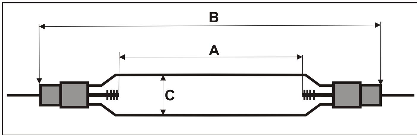
**A= Elektrodenabstand Arc Length** 102 mm
