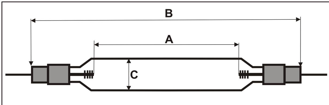
**A= Elektrodenabstand Arc Length** 157 mm **Socket / Base: 70**
