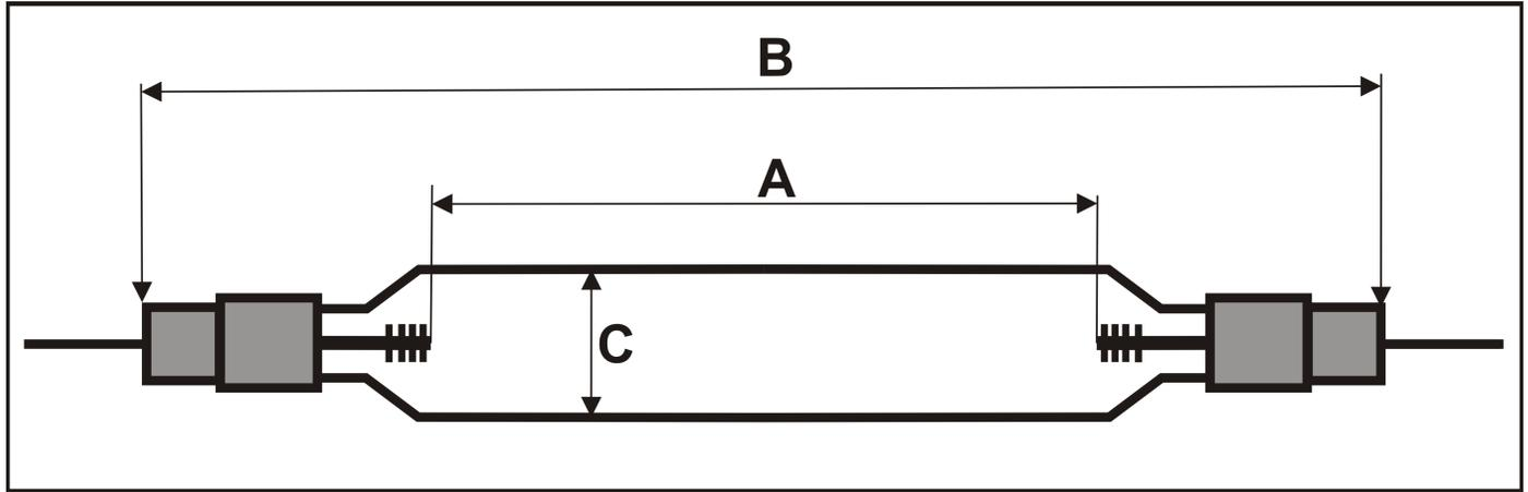
**A= Elektrodenabstand Arc / Length:** 100 mm
