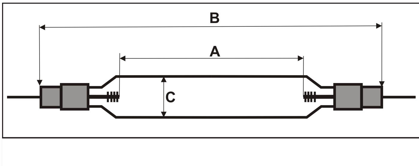
**A= Elektrodenabstand Arc Length** 1035 mm **Sockel / Base:** 46
