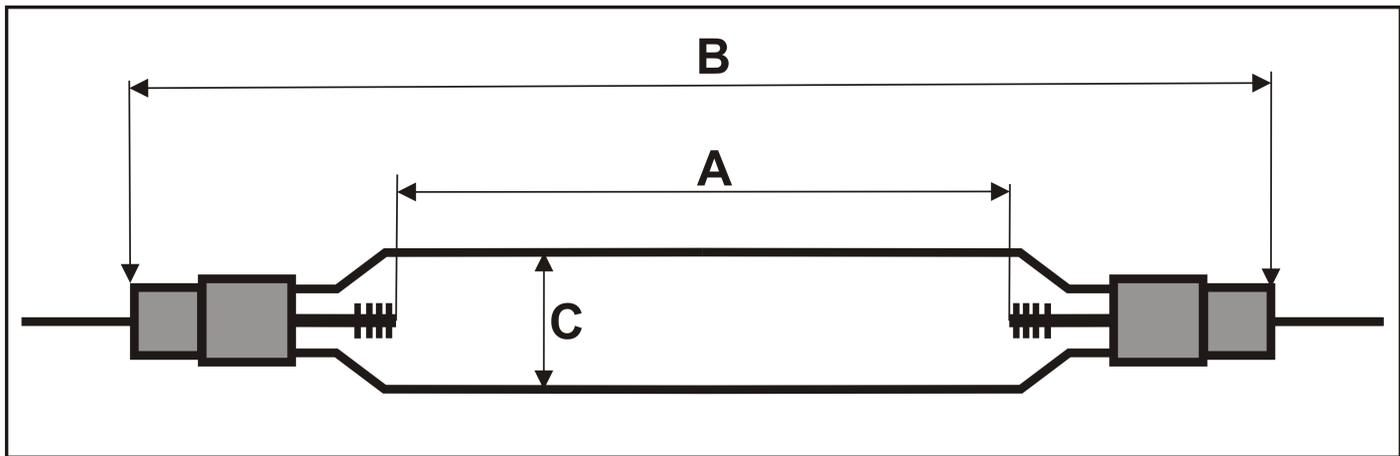
**A= Elektrodenabstand Arc Length** 552 mm
